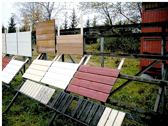
Provning av väderbeständighet för Bruksklass EXT. t.v. Accelererad åldring; t. h. Naturlig utomhusexponering
